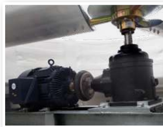
Estándar: Sistema de transmisión con caja reductora
